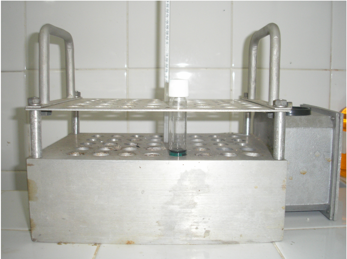
Figura 11. Forno de aquecimento resistivo e termocontrolado, utilizado na digestão dos tubos de DQO.
