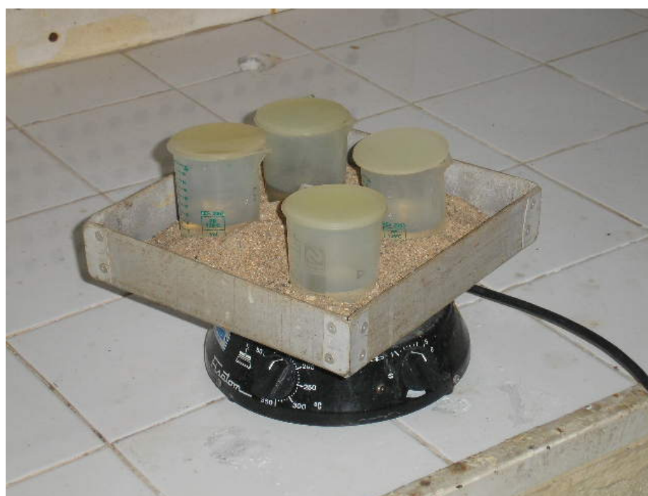
Figura 12. Sistema de digestão ácida do chorume em sistema aberto, sob aquecimento em areia.
