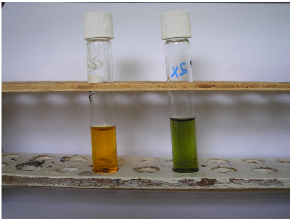
Figura 13. Tubos tipo Hach utilizados na determinação de demanda química de oxigênio (variável-resposta principal do tratamento do chorume).
