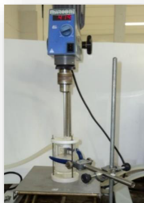
Figura 4.1 - Esquema da reação de esterificação do álcool isoamílico ou óleo fúsel com ácido esteárico ou oleico
