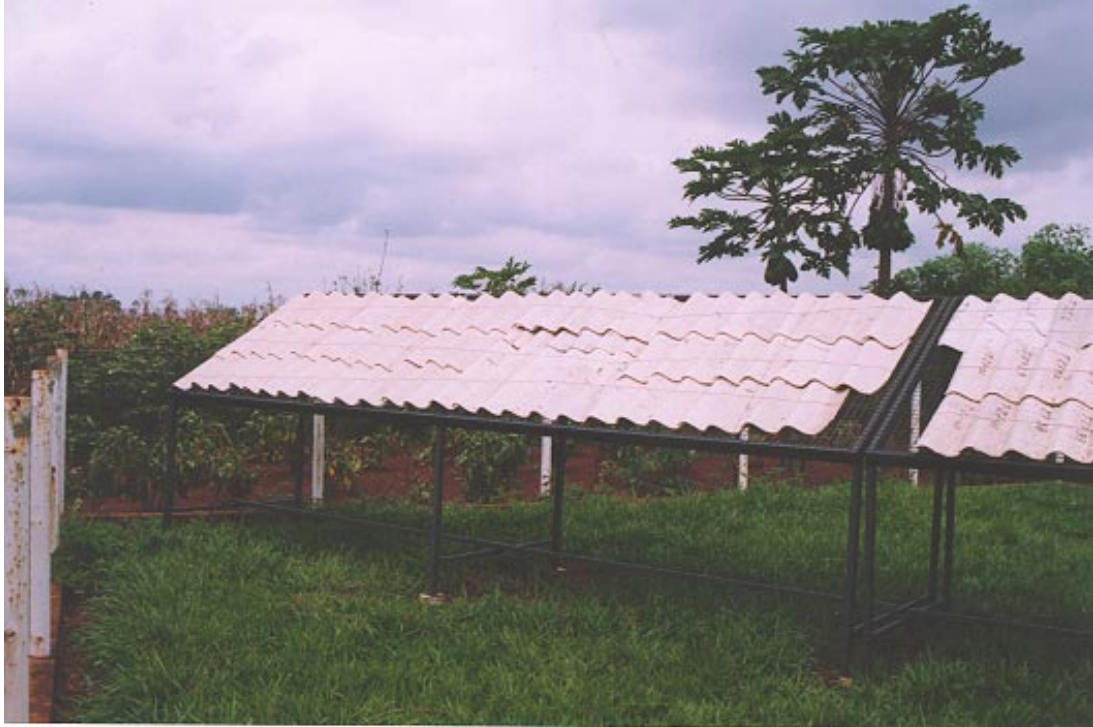
Fig. 4.12 Bancada de envelhecimento natural no Câmpus da USP de Pirassununga SP.
