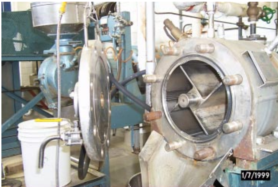
Fig. 5.2 Desfibrador Asplund utilizado em estágio termo-mecânico do processo CTMP.
