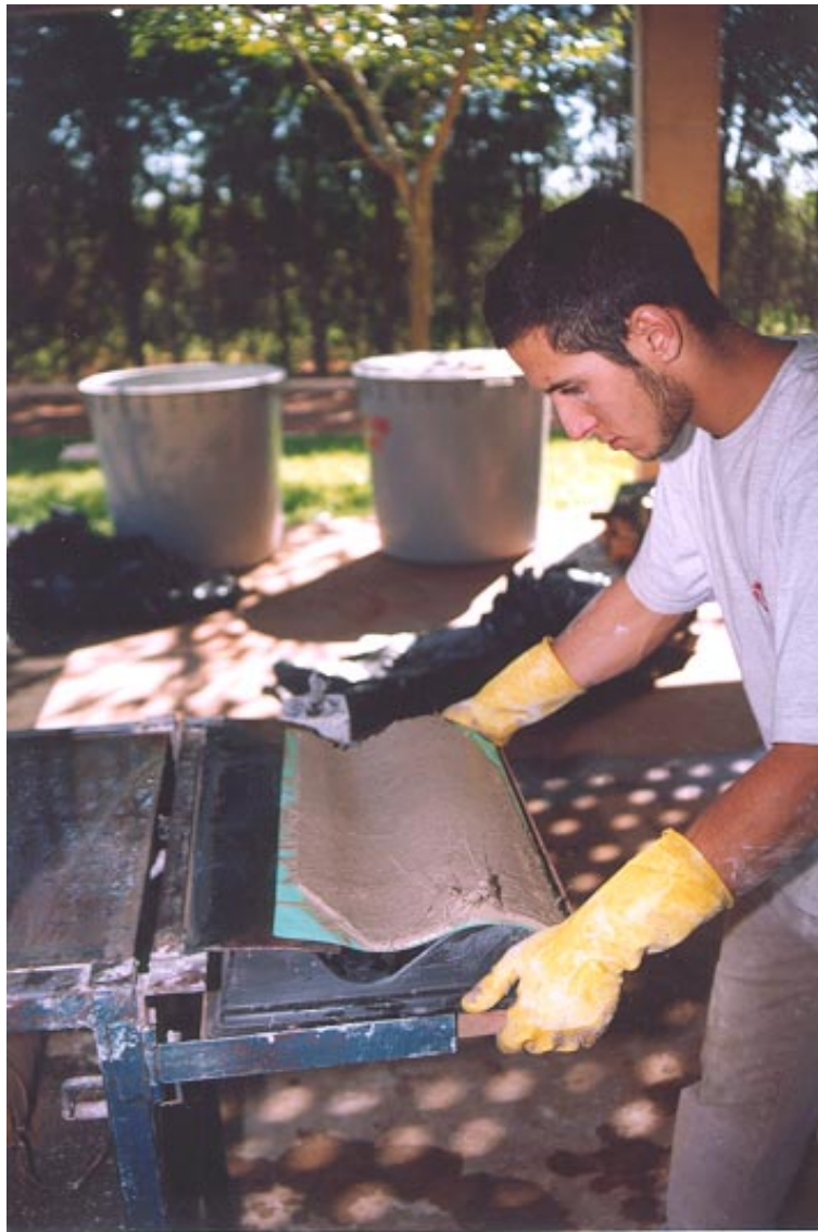
Fig. 4.2 Telha sendo transferida para fôrma ondulada.
