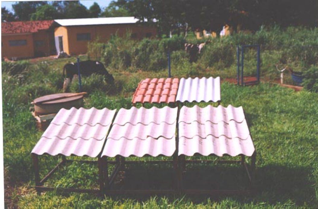
Fig. 4.15 Modelos reduzidos de telhados para ensaio de conforto térmico.
