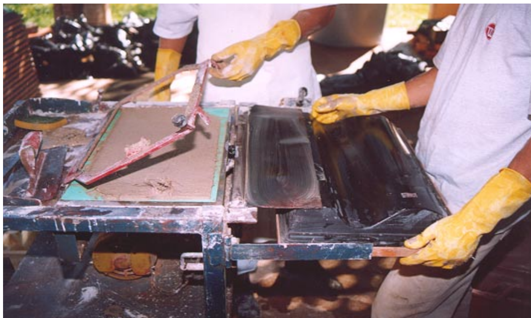
Fig. 4.1 Produção da telha. Placa recém-moldada e vibrada.
