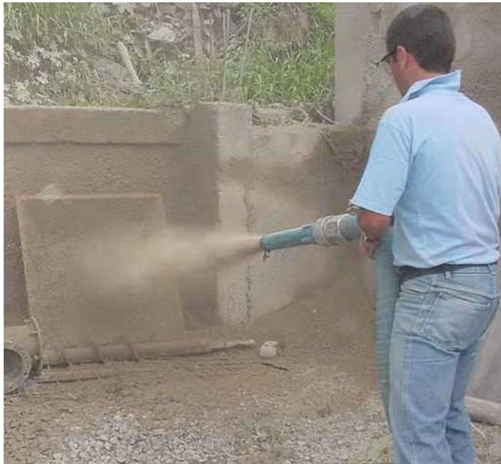
Figura 3.3 – Moldagem de placas para extração de testemunhos para a execução dos ensaios de determinação da tenacidade em prismas (Abreu, 2004).
