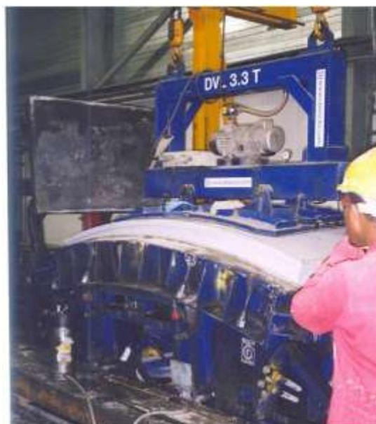
Figura 5.4 – Sistema do tipo ventosa utilizado para a remoção dos segmentos das fôrmas utilizado na produção dos anéis segmentados da obra do prolongamento do Eurotúnel em Londres (Figueiredo, 2003b).
