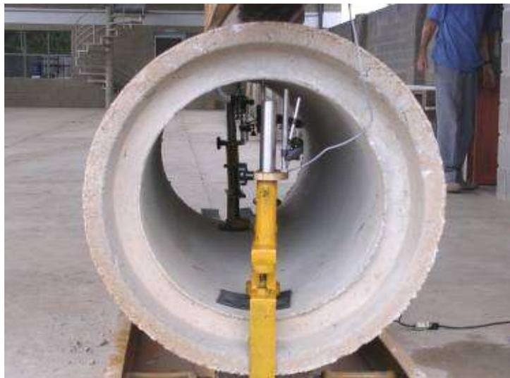
Figura 6.22 – configuração inicial do sistema de posicionamento dos LVDTs para medida contínua de deslocamento dos tubos de concreto (Figueiredo et al., 2007).
