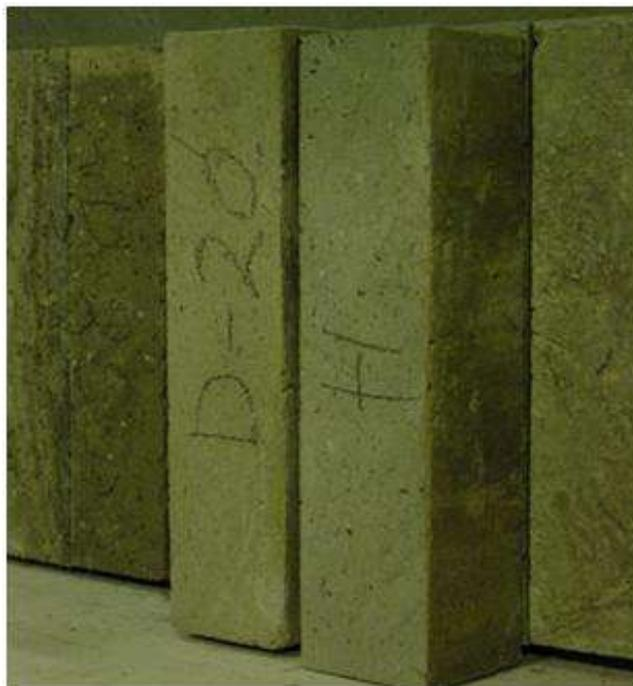
Figura 3.4 – Prismas cortados de placas de concreto projetado destinados ao ensaio de tração na flexão com deformação controlada para determinação da tenacidade (Figueiredo, 2003a).
