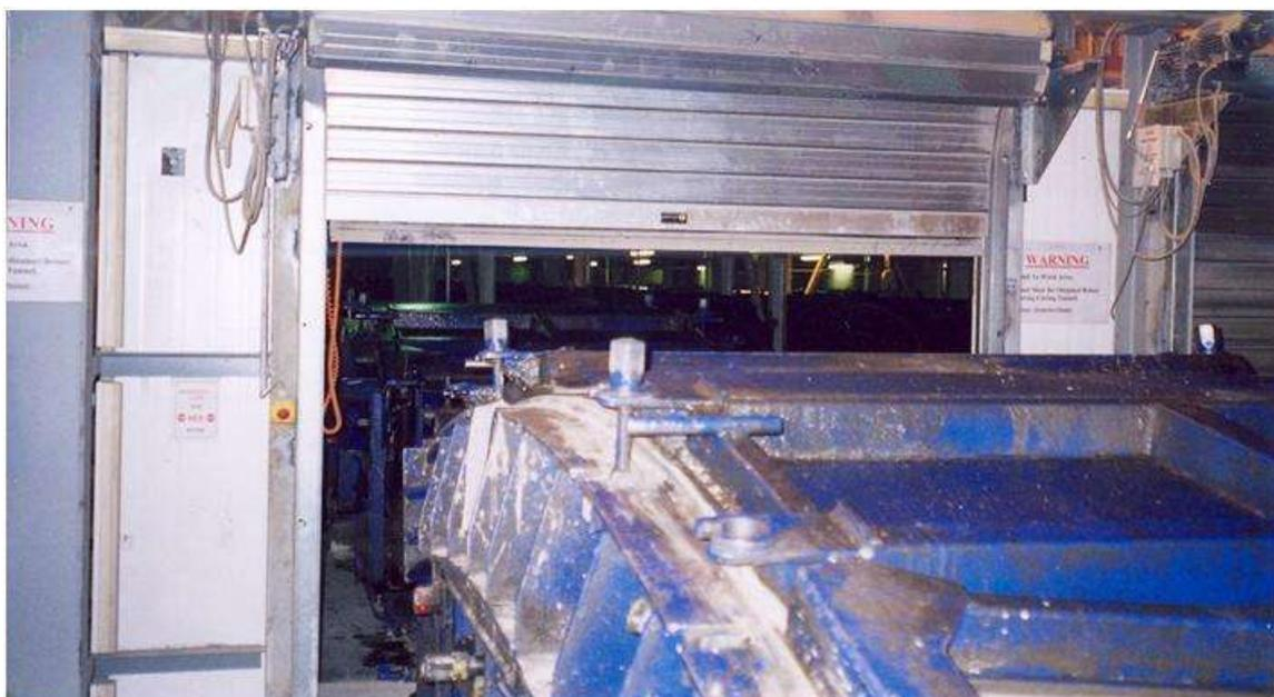
Figura 5.7 – Segmento de anel pré-moldado entrando em câmara de vapor para aceleração da cura na fábrica da obra do prolongamento do Eurotúnel em Londres (Figueiredo, 2003c).
