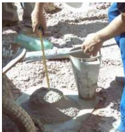
Figura 4.13 – Determinação do abatimento de tronco de cone previamente à projeção do concreto (Figueiredo, 2005c).
