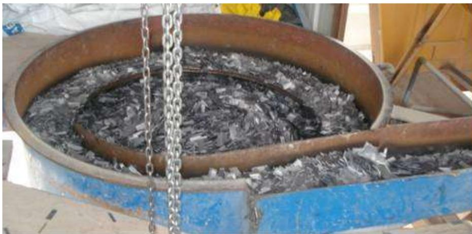
Figura 5.2 – Sistema de alimentação contínua de fibras para o misturador que produzirá o concreto destinado à moldagem dos anéis segmentados da obra da Linha 4 Amarela do Metrô de São Paulo (Faria, 2008b).
