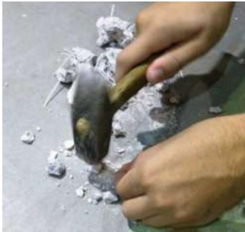
Figura 3.29 – Esmagamento manual dos pedaços de corpo-de-prova para separação das fibras aderidas (Kalil; Escariz; Figueiredo, 2010).
