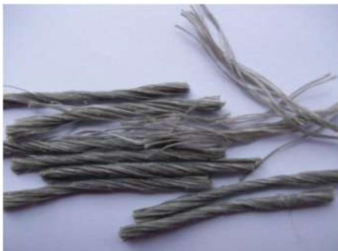
Figura 2.7 – Macrofibras poliméricas fornecidas como uma mescla de fibras de baixo e de alto módulo de elasticidade (Figueiredo, 2011).
