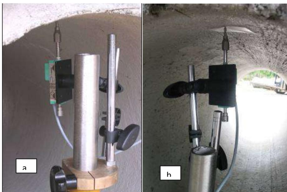
Figura 6.23 – (a) detalhe do suporte para posicionamento do LVDT para leitura do deslocamento do tubo de concreto durante o ensaio de compressão diametral e (b) da folha de acetato que evitava a entrada da agulha em uma possível fissura (Figueiredo et al. 2007).
