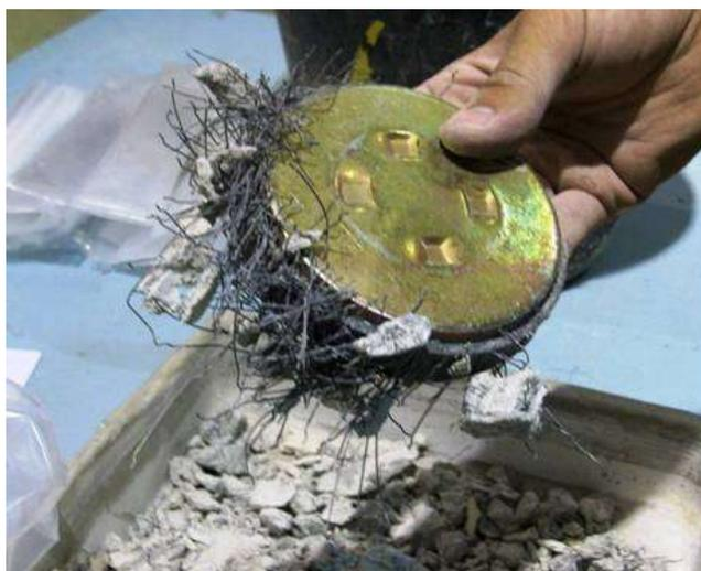
Figura 3.26 – Coleta de fibras de aço de um concreto através do uso de um ímã (Kalil; Escariz; Figueiredo, 2010).
