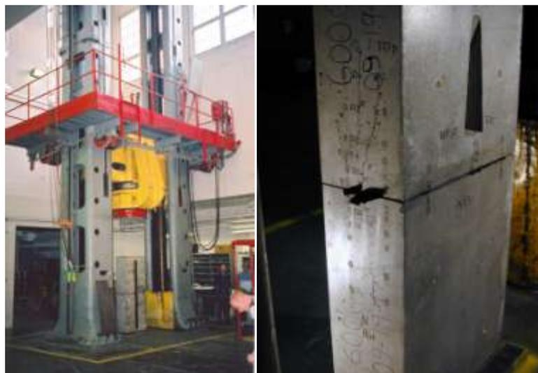
Figura 5.6 – Ensaio de compressão topo a topo de prismas para avaliação do concreto destinado à produção de anéis segmentados para revestimento de túneis com tuneladora (Mike King, 2003).
