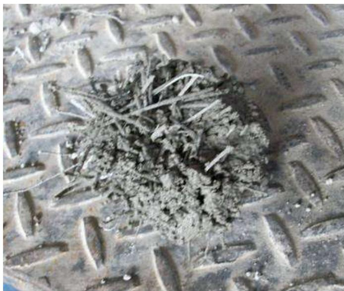
Figura 6.12 – Ouriço formado por macrofibras poliméricas mal misturadas ao concreto destinado à execução de tubos (Figueiredo, 2010n).
