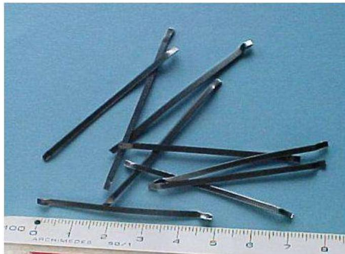
Figura 2.2 – Fibras de aço tipo A-II segundo a norma ABNT NBR 15530 (2007) produzida a partir de chapas de aço cortadas (Figueiredo, 2005a).
