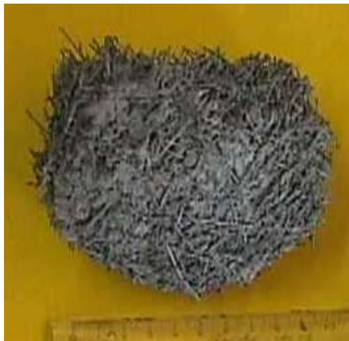
Figura 3.24 – Ouriço formado por fibras de aço mal misturadas ao concreto (Figueiredo, 2000).
