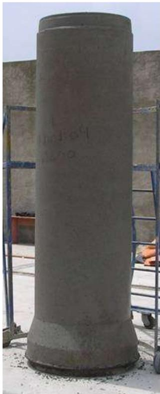
Figura 6.13 – Tubo de CRF apresentando bom acabamento superficial (Figueiredo, 2008c).
