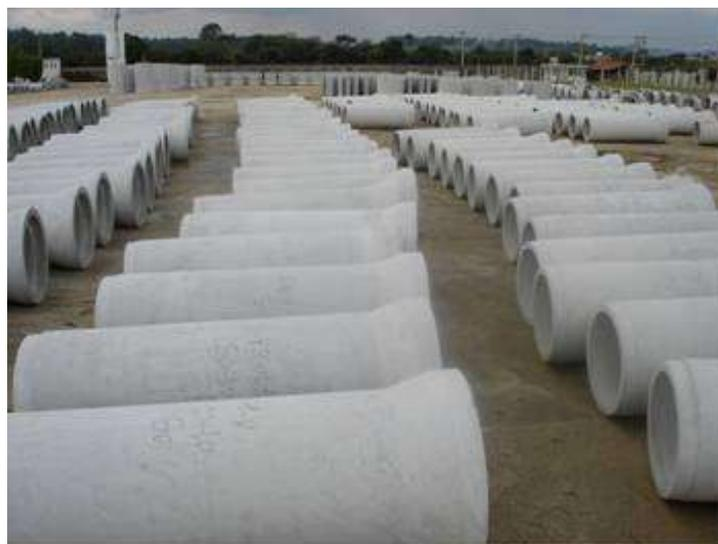
Figura 6.8 – Pátio de armazenamento dos tubos de concreto na fábrica (Figueiredo, 2005e).
