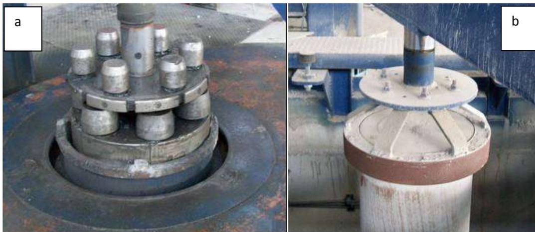
Figura 6.6 – Sistemas utilizados para a compactação do concreto no interior da fôrma pelo sistema de compressão radial (a) (Figueiredo, 2010g) e vibro-prensado (b) (Figueiredo, 2010h).
