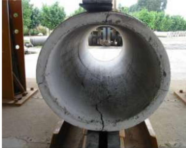
Figura 6.17 – Tubo de CRF sendo submetido ao ensaio de compressão diametral (Figueiredo; Chama Neto, 2008).
