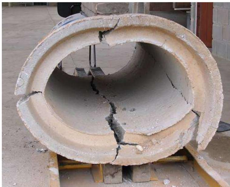
Figura 6.47 – Tubo rompido com grande nível de deslocamento exibindo as quatro principais rotulações no coroamento, base e flancos(Figueiredo, 2005g).
