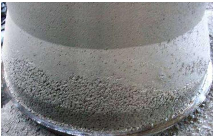
Figura 6.14 – Região com falta de pasta de um tubo de CRF junto à região da bolsa originado pelo aumento de coesão proporcionado pela adição de fibra (Figueiredo, 2010o).
