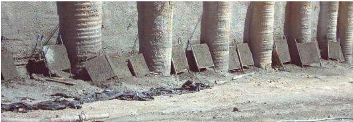
Figura 4.17 – Série de placas moldadas com um mesmo teor e tipo de fibra (Figueiredo, 2005c).
