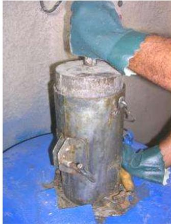
Figura 6.50 – Moldagem dos corpos de prova cilíndricos com soquete sobre mesa vibratória (Figueiredo; Chama Neto, 2010).
