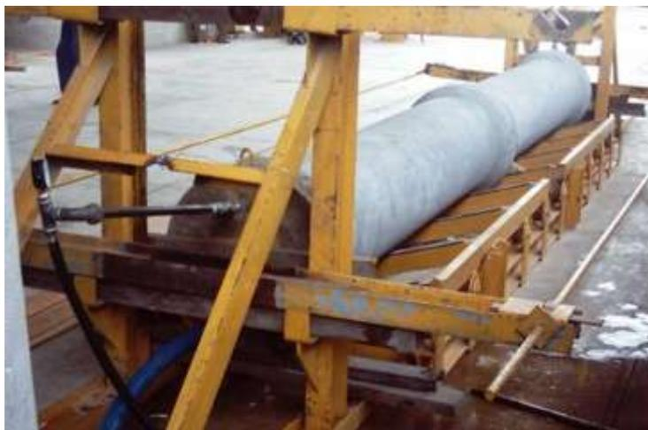
Figura 6.20 – Tubos de concreto submetidos ao ensaio de estanqueidade conforme o preconizado pela norma ABNT NBR 8890 (2007) (Figueiredo, 2005f).
