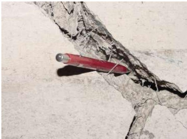
Figura 3.17 – Detalhe do nível de fissuração atingido durante a realização do ensaio de puncionamento de placas quadradas (Figueiredo, 2008b).
