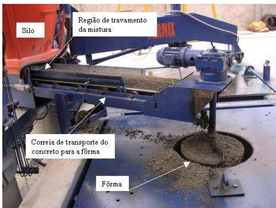
Figura 6.11 – Situação em que houve bloqueio da movimentação da mistura destinada à moldagem de um tubo de concreto devido a adição de fibras sem ajuste do traço (Figueiredo, 2008c).
