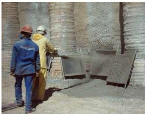
Figura 4.16 – Detalhe da moldagem de placas (Figueiredo, 2005c).
