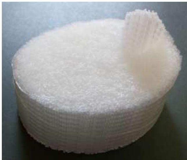
Figura 2.5: Cilindro de macrofibras poliméricas produzido para lançamento direto na betoneira para mistura no concreto (Figueiredo, 2010a).
