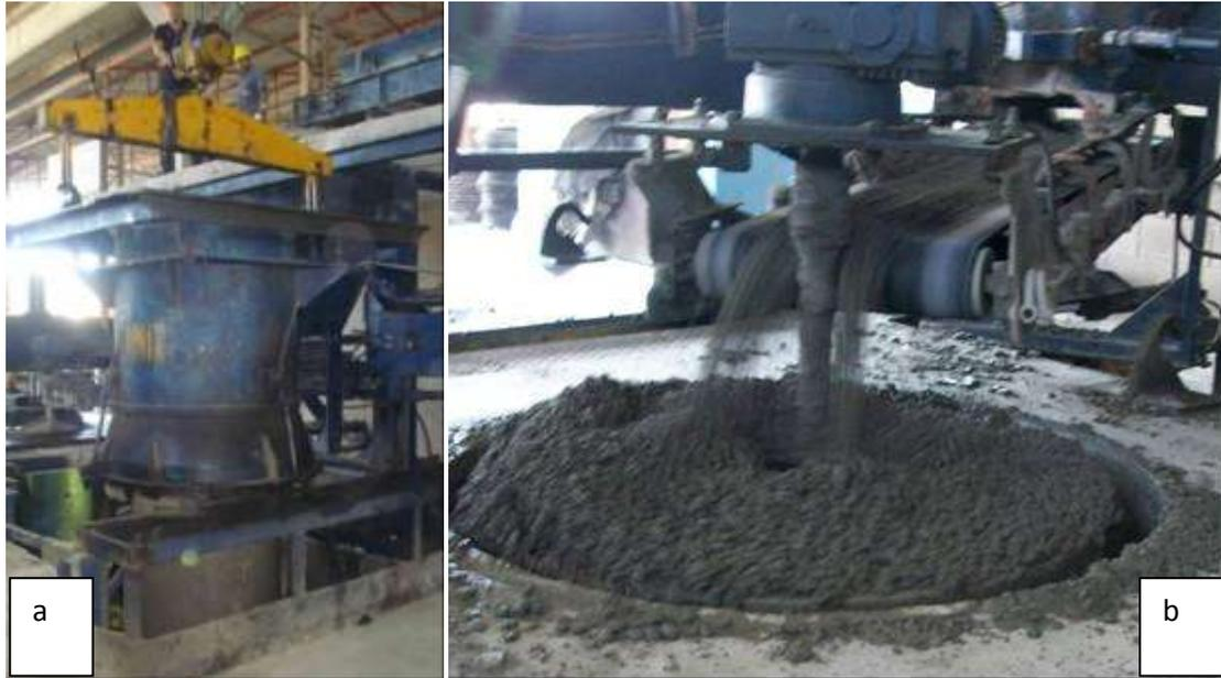
Figura 6.5 – Posicionamento da fôrma na máquina de produção dos tubos (a) (Figueiredo, 2010e) e lançamento do concreto (b) (Figueiredo, 2010f).
