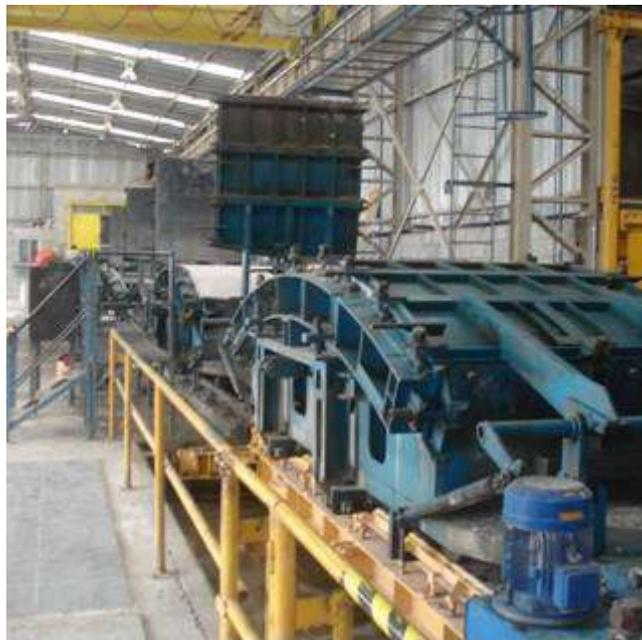
Figura 5.1 – Linha de montagem das fôrmas metálicas destinadas à produção dos anéis segmentados da obra da Linha 4 Amarela do Metrô de São Paulo (Faria, 2008a).
