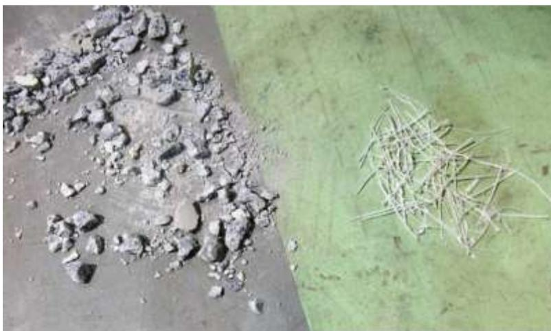
Figura 3.30 – Macrofibras poliméricas separadas manualmente após o esmagamento dos pedaços de corpo-de-prova onde estavam aderidas (Kalil; Escariz; Figueiredo, 2010).
