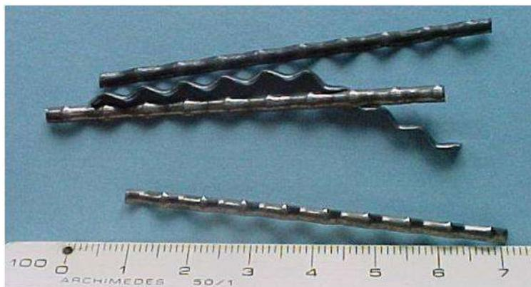
Figura 2.3 – Fibras de aço tipo C-III segundo a norma ABNT NBR 15530 (2007) produzida a partir fios de aço escarificados (Figueiredo, 2005a).
