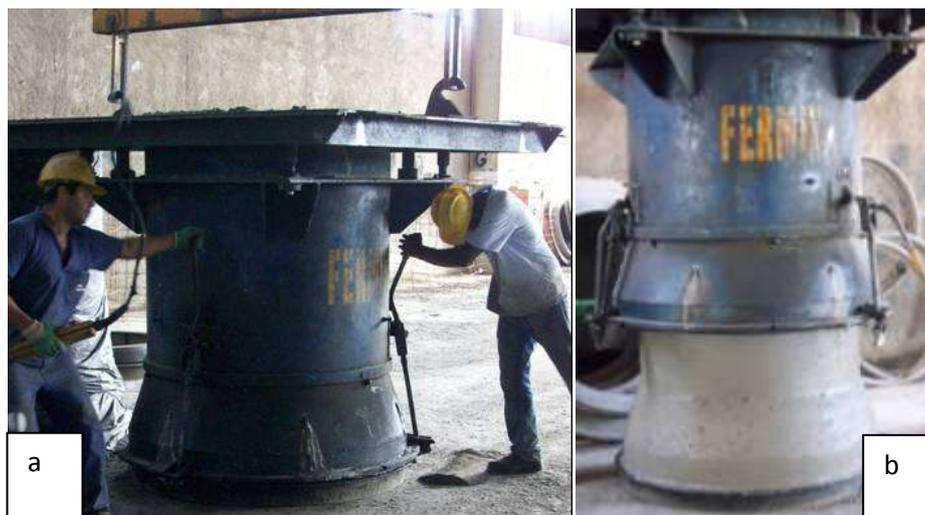
Figura 6.7 – Posicionamento do tubo recém moldado no local onde permanecerá em cura (a) (Figueiredo, 2010i) e desfôrma (b) (Figueiredo, 2010j).
