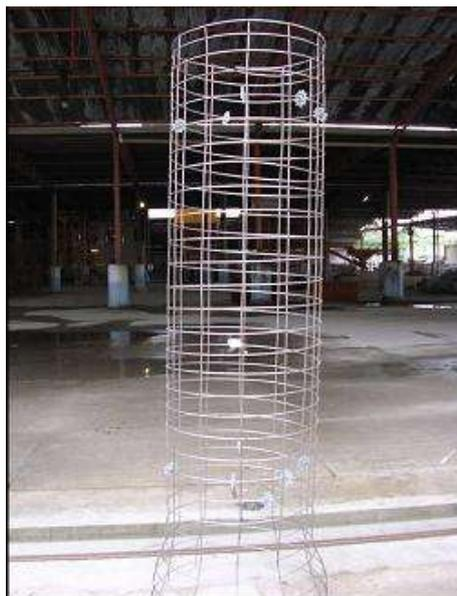
Figura 6.33 – Armadura utilizada nos tubos de reforço convencional que serviram de parâmetro para a análise comparativa de desempenho (Figueiredo et al.; no prelo).
