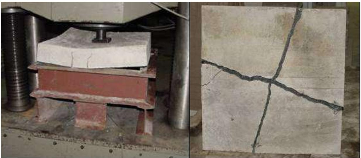
Figura 3.16 – Ensaio de puncionamento de placas quadradas com elevado nível de deformação e fissuração (Figueiredo, 2008b).
