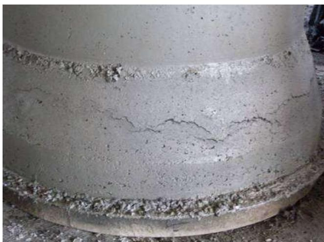
Figura 6.15 – Fissuração de tubo de CRF junto à região da bolsa devido ao aumento de coesão proporcionado pela adição de fibra (Figueiredo, 2010p).
