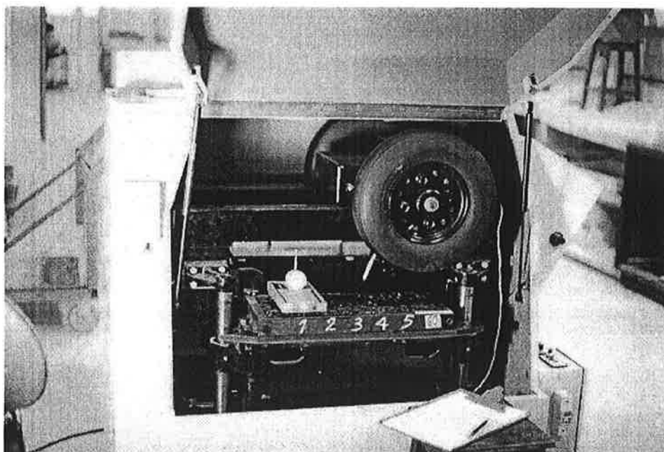
Figura 37: Simulador de tráfego tipo LPC (Laboratoire des Ponts et Chaussées) para determinação de deformação permanente em trilha de roda instalado no Laboratório de Tecnologia de Pavimentação - EPUSP.
