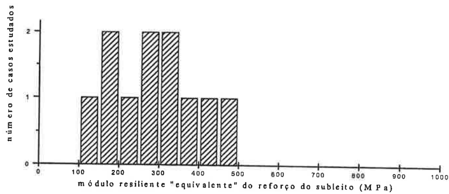
Figura 16: Módulos de resiliência equivalentes de reforços do subleito de solos lateríticos obtidos a partir de retroanálise de bacias de deflexão de vários trechos de 7 diferentes rodovias (Bernucci, 1995).
